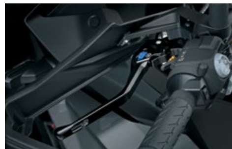
Dźwignia sprzęgła 57600-48810-000 Sportowe dźwignie, precyzyjnie wykonane z najwyższej jakości aluminium. Czarne, anodowane. Z logo "SUZUKI". W zestawie regulator dźwigni, w dwóch kolorach do wyboru - czerwony / niebieski.
